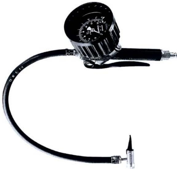
Der klassische Handreifenfüllmesser ist der Bauart nach zugelassen. Geräte für den Gebrauch an öffentlichen Tankstellen (mit Messbereich 0-4 bar und 0-10 bar) sind von der Eichbehörde zugelassen und geeicht (Eichplakette auf der Manometerscheibe). Die Gültigkeit der Ersteichung beträgt 2 Jahre. Nach Ablauf der Eichfrist muss das Gerät nachgeeicht werden.
